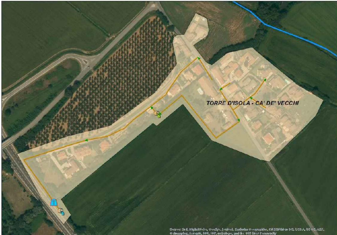
Ca' de' Vecchi carico trattato 116 AE, potenzialità 100 AE. Giudizio ARPA (2014) di non conformità. Capacità insufficiente rispetto a carico in ingresso. Previsti lavori di adeguamento tra 2016 e 2019.
