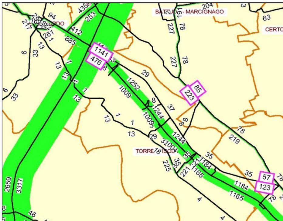
Stralcio da tavola n.15 del PTVE, Provincia di Pavia, 2007 – flussi di traffico rilevati nell'ora di punta 7.00 – 8.00
