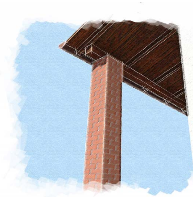
I porticati con struttura lignea e pilastri in mattoni a vista
