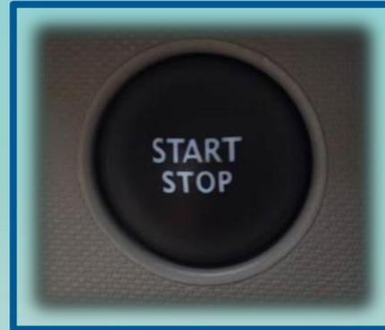
INSERISCI LE CHIAVI NEL QUADRO E, TENENDO PREMUTO IL PEDALE DEL FRENO, PREMI IL TASTO "START & STOP" A DESTRA DEL VOLANTE, MANTENENDO IL CAMBIO IN POSIZIONE "P" DI PARCHEGGIO.
