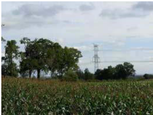
Fig 16. La scelta del tracciato: laddove risulti possibile è opportuno gemellare le linee elettriche per evitare tracciati paralleli inutili che sovraccaricano la vista.
