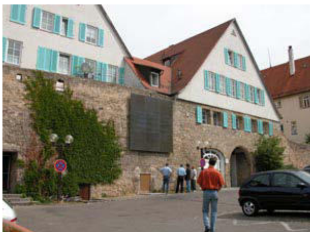
Fig. 58. Tavola solare con citazione di Schiller sulle mura di Marbach am Neckar: il tabellone è costituito da moduli solari a pellicola sottile di grande dimensione (1,20 m x 1,20 m) realizzati con colori, simili alla struttura e alla tonalità della pietra naturale di sfondo, in modo da garantire un inserimento armonico sulle mura storiche della città.
