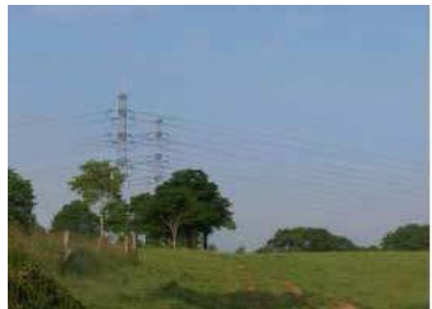
Fig 13. La struttura del paesaggio: un paesaggio con elementi costitutivi di piccole dimensioni implica una visione a distanza ravvicinata per la complessità di elementi che lo frammentano (boschetti, filari alberati, siepi). In questo caso sarà più semplice mitigare l'impatto generato dall'introduzione di una linea elettrica facendo sì che il tracciato segua il disegno delle partizioni territoriali già presenti e degli elementi verticali.
